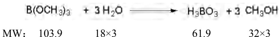
6300L 搪玻璃水解釜中，通过盐酸计量罐加入盐酸 300L，加入水 1200L，搅拌下将不锈钢低温釜的物料加入水解，水解过程控温不超过 50℃，物料加完后再充分搅拌 30min，静置。
